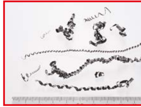
Eğimli yüzey işleme
